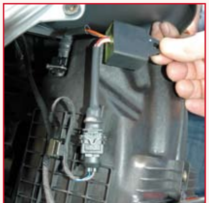
Il montaggio della centralina sulla R 1200R è un po' più lungo, perché il sensore è in alto davanti all'airbox e bisogna sollevare il serbatoio. A quel punto basta inserire in serie la centralina e il gioco è fatto.
